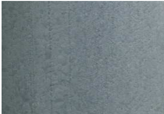
Dieses Foto zeigt ein sendzimirverzinktes Blech mit Zinkblume und Zinkpatina (dunkelgraue, matte Oberfläche)
