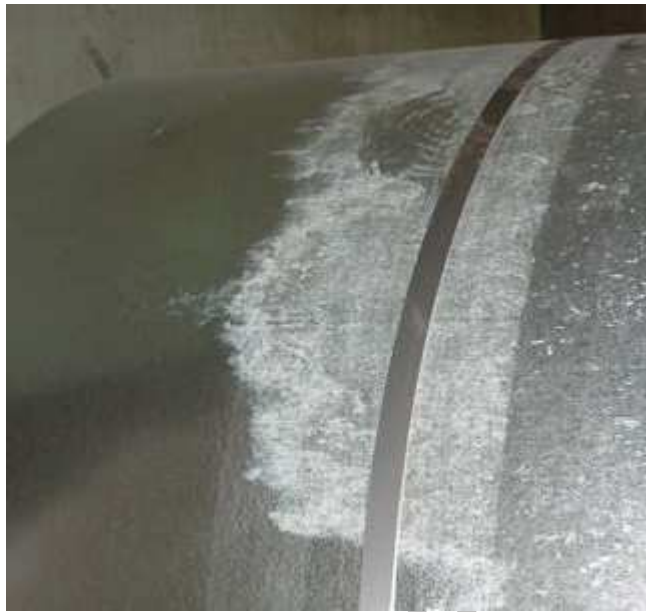
Feuerverzinkter Coil mit flächigem Weißrost
